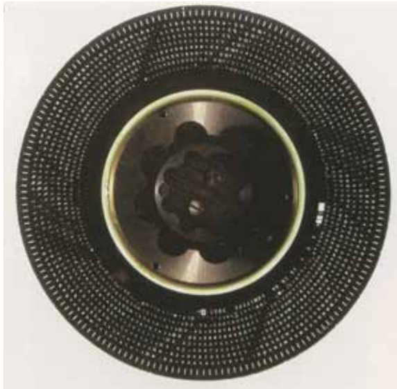
(6) Disque porte-matrices de la photocomposeuse Lumitype-Photon.
